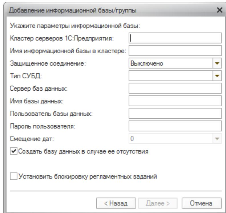
Рисунок 9 Окно добавления информационной базы. Настройка параметров базы
